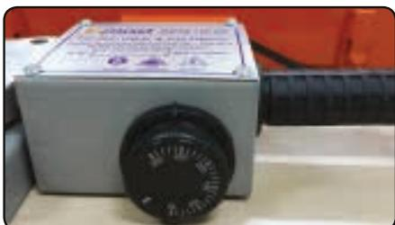
**1** Makine soğukken paftaları kaynak makinesine sıkıca monte edin. Fisi takın ve kaynak makinesini 260 °C'ye kadar ısıtın.
