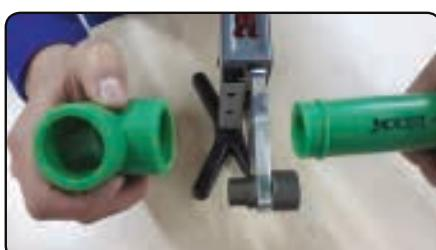
**5** Yeterince ısındıktan sonra boruyu ve bağlantı elemanını çıkarın, ısıtılmış boruyu hemen eklemeye parçası içerisine doğru ilerletin. Boruyu işaretlediğiniz kaynak derinliğine kadar döndürmeden itin.
