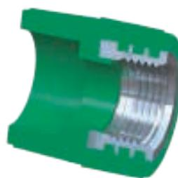
Dışlı birleştirmelerde sızdırmazlık uygulanması gereklidir. İç ve dış metal dışlılarda sadece Teflon bant kullanılabilir! Demir konik dışlı veya ölçüsü hatalı dışlılar yüksek sıkma kuvvetlerinde kırılabilceğinden birleştirmeden kaçınılması tavsiye edilir.
