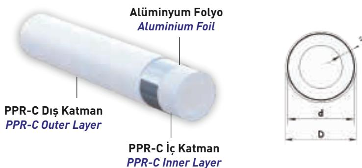
Uygulanabilir boru boyut sınıfı için ortalama boru dış çapı;  $d_{em}$  /  $D_{em}$  ve boru et kalınlığı;  $s_{min}$ , Tablo-4 e uygun olmalıdır.
