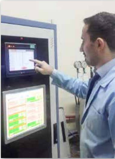
İç basınca dayanıklılık testi Resistance to internal pressure test
